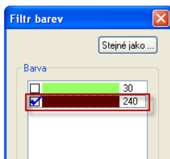
Obrázek 1.21 – Nastavení konkrétní barvy dle které bude probíhat obrábění
