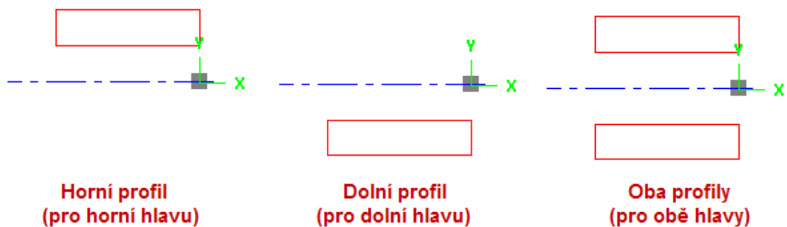
Obrázek 2.59 – Tři základní způsoby tvorby soustružnického profilu
