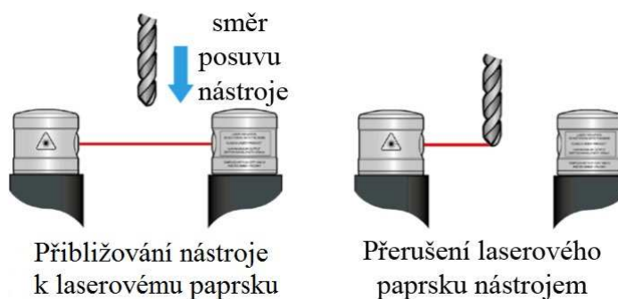
Obr. 4.5 Bezkontaktní měření nástrojovou sondou ( double-sided ) [25].
