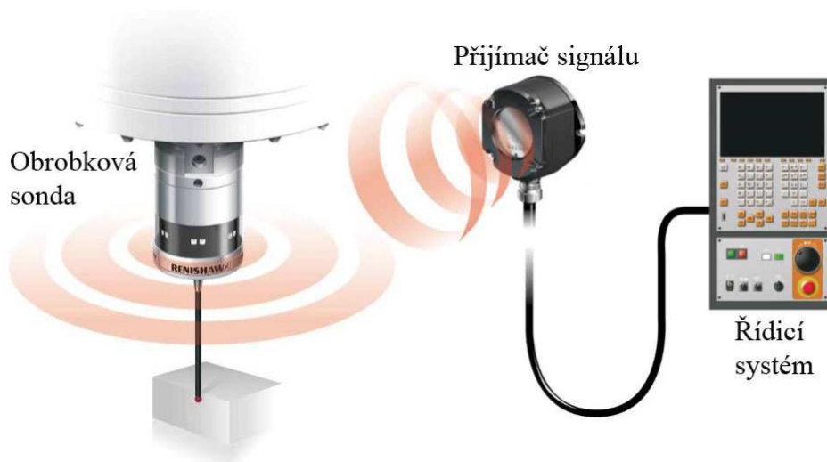
Obr. 4.2 Schéma přenosu signálu z obrobkové sondy do řídicího systému [25].
