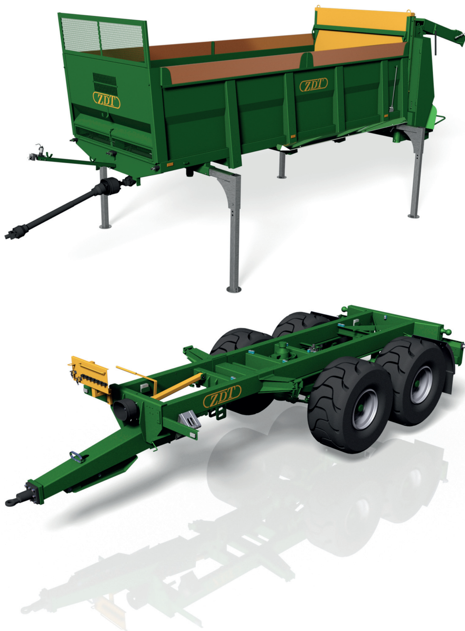
Obrázek 12.9 Rozmetadlo chlěvké mrvy a nosič výměnných nástaveb Mega 20, Zemědělská a dopravní technika, Nové Veselí, Česká republika ( www.zdt.cz )
