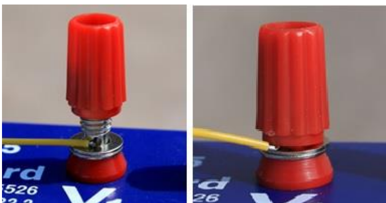
Obr. 4.3: Zasunutí vodiče do otvoru v konektoru a utažení konektoru
