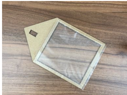
Obr. 13 – Nalepení fólie na stěny
