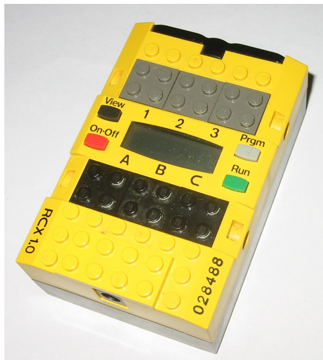
Obrázek 2.1: LEGO MINDSTORMS RCX 2
