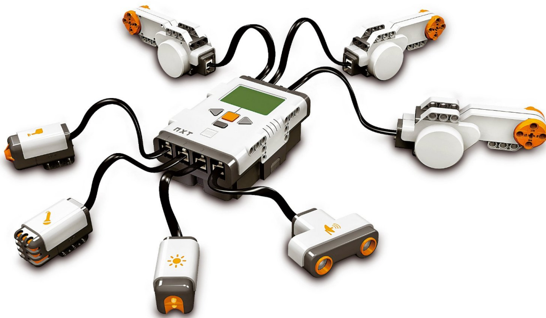
Obrázek 2.2: LEGO MINDSTORMS NXT s komponenty, které lze používat 4
